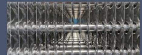
**Fluchtendes Rohrsystem für erhöhten Reifspeicher**
